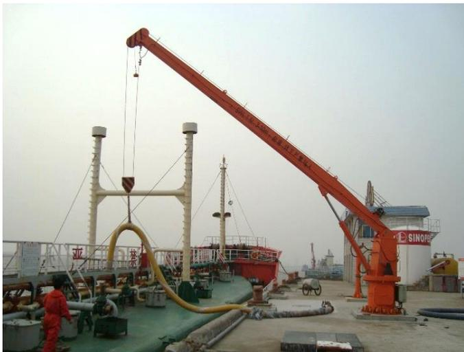
Equipamento utilizado para içar a mangueira que conecta o gasoduto do cais ao navio de carga. Eles podem ser projetados de acordo com o envelope de operação, para atender aos requisitos de carregamento de diferentes produtos em navios a serem carregados ou descarregados por mangueiras. As principais especificações são listadas na tabela a seguir:
