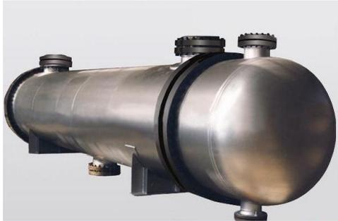
É um trocador de calor de parede com a superfície da parede do feixe de tubos contida no invólucro como superfície de transferência de calor. O trocador de calor tem as vantagens de estrutura simples, baixo custo, seção de circulação ampla e fácil limpeza de incrustações. Pode ser feito de vários materiais estruturais (principalmente materiais metálicos) e pode ser usado em alta temperatura e alta pressão, sendo um dos tipos mais amplamente utilizados.
